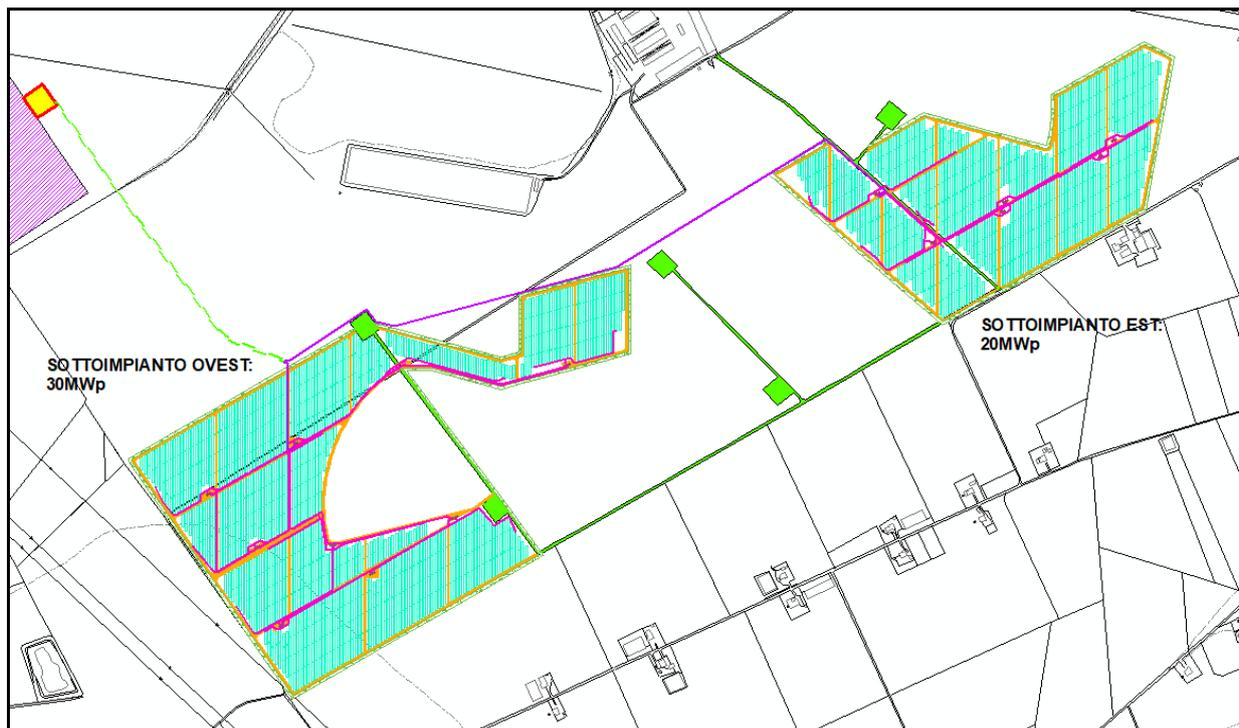
*Fig.22 . Layout impianto con la suddivisione in due sottoimpianti virtualmente indipendenti.*
