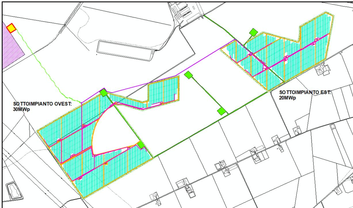
*Figura 6. Layout impianto con la suddivisione in due sottoimpianti virtualmente indipendenti.*
