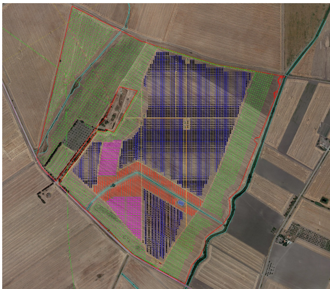
Figura 13 – Layout dell'impianto agrivoltaico del "Lotto Castelluccio dei Sauri" su ortofoto.
