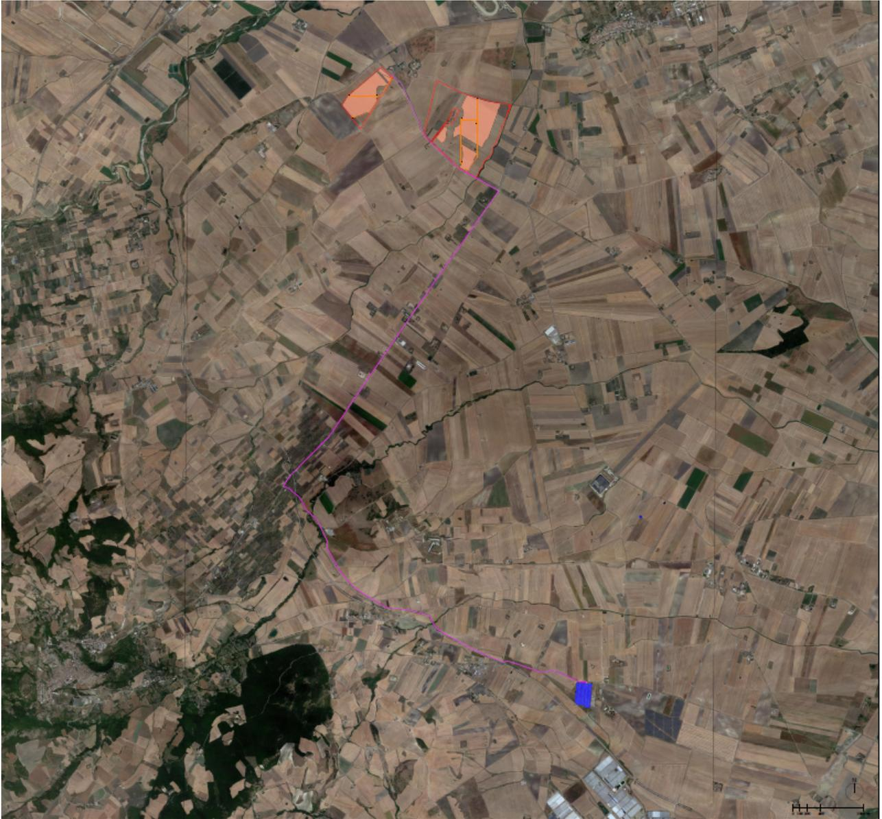
*Figura 3: inquadramento territoriale su ortofoto dell'area di impianto; in magenta è stato rappresentato il tracciato delle dorsali a 36 kV di collegamento con la Stazione Elettrica di Deliceto (area blu).*
