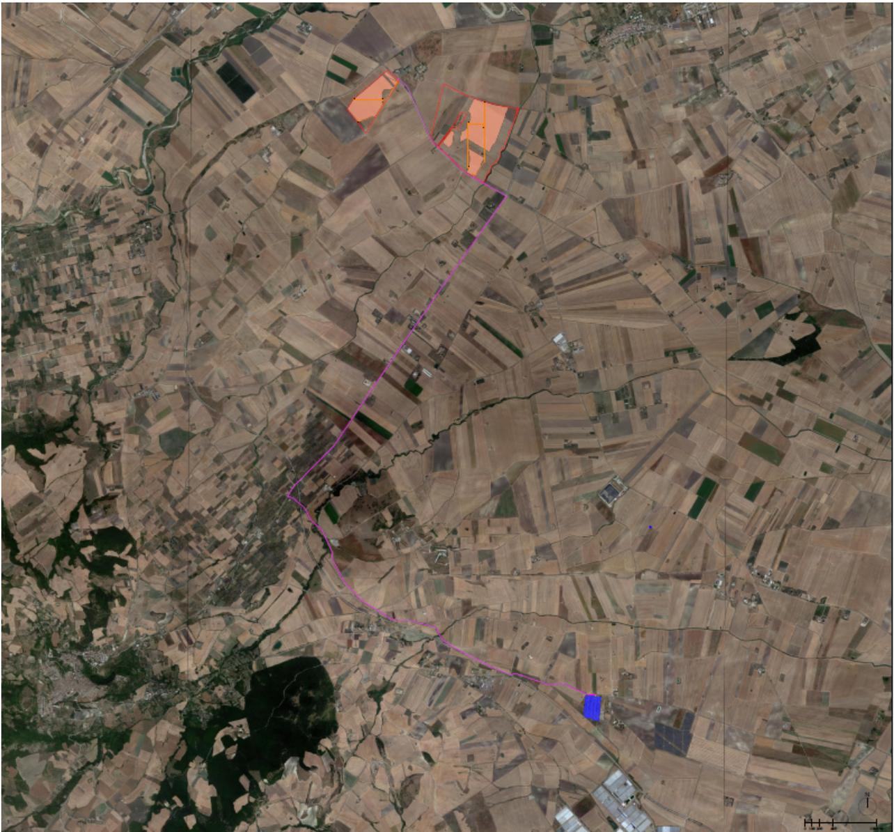
*Figura 11: inquadramento territoriale su ortofoto dell'area di impianto, con rappresentazione del tracciato delle dorsali a 36 kV (in magenta) di collegamento con la Stazione Elettrica di Deliceto campita in blu*
