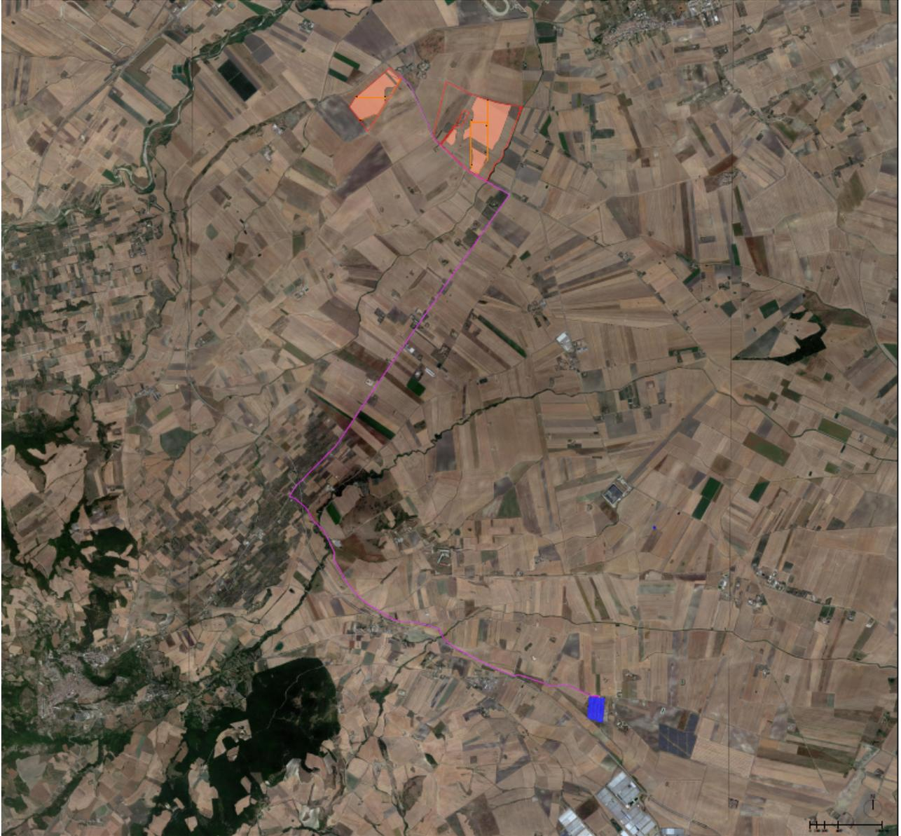
*Figura 3: inquadramento territoriale su ortofoto dell'area di impianto; in magenta è stato rappresentato il tracciato delle dorsali a 36 kV di collegamento con la Stazione Elettrica di Deliceto (area blu).*
