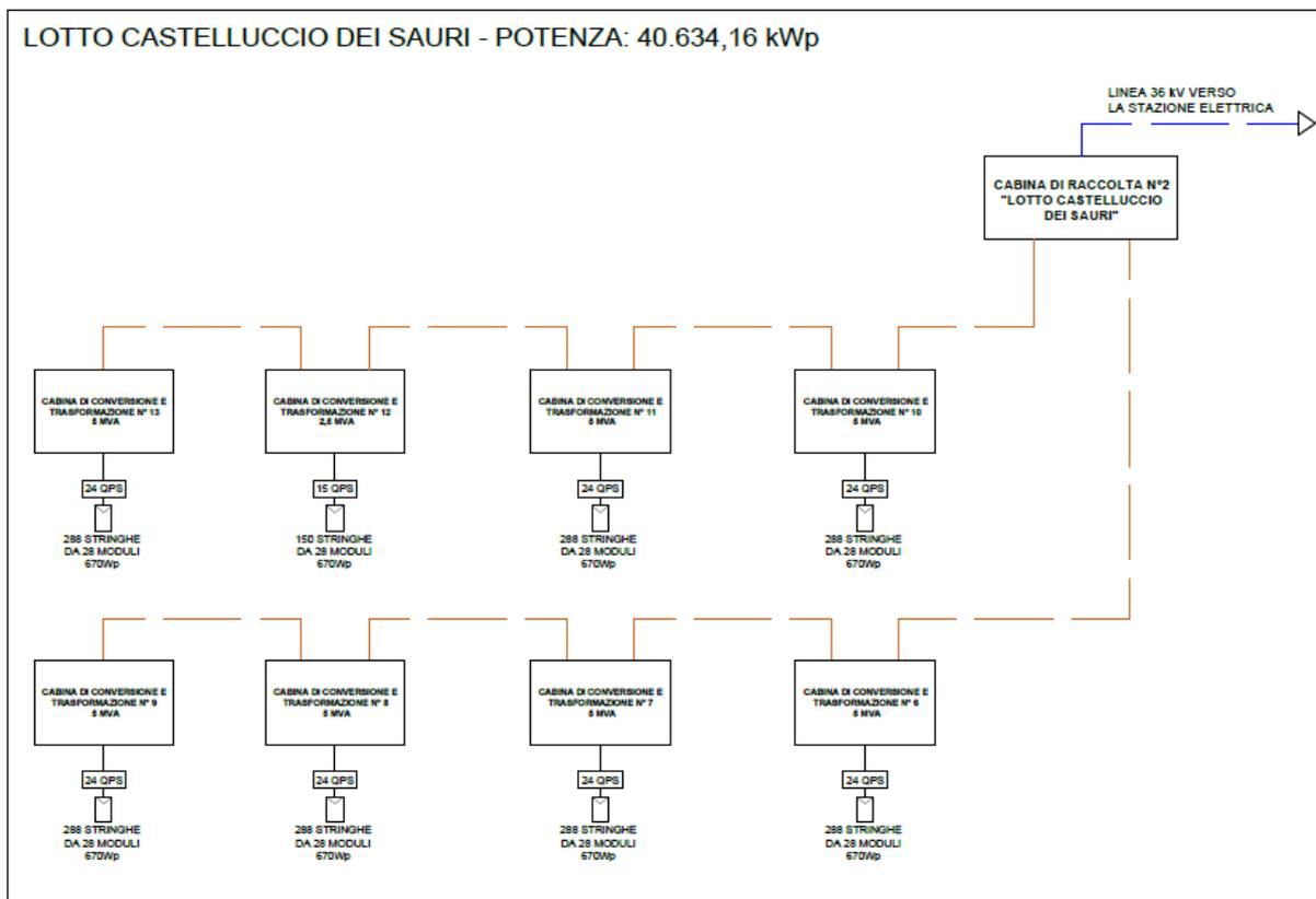
Figura 5: schema a blocchi corrispondente al Lotto Castelluccio dei Sauri con indicazione della dorsale di collegamento a 36 kV con la Stazione Elettrica Terna denominata Deliceto
