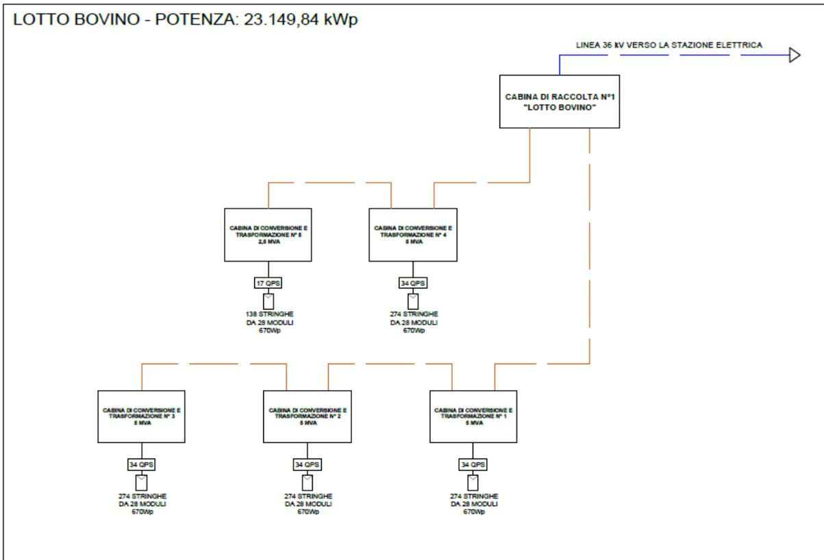
Figura 4: schema a blocchi corrispondente al Lotto Bovino con indicazione della dorsale di collegamento a 36 kV con la Stazione Elettrica Terna denominata Deliceto
