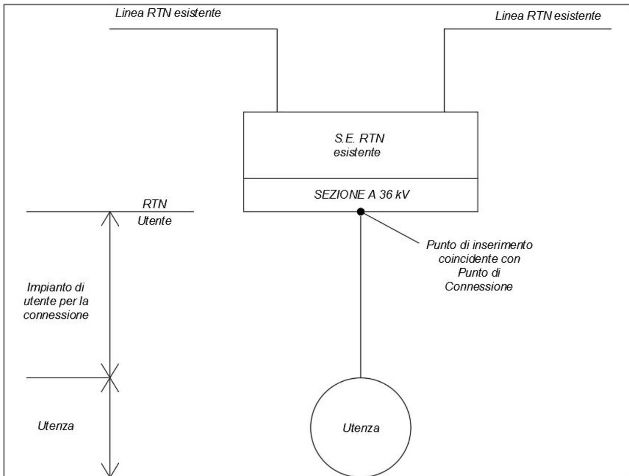
*Figura 2: impianto di produzione collegato in antenna con la sezione a 36 kV di una Stazione Elettrica Esistente*
