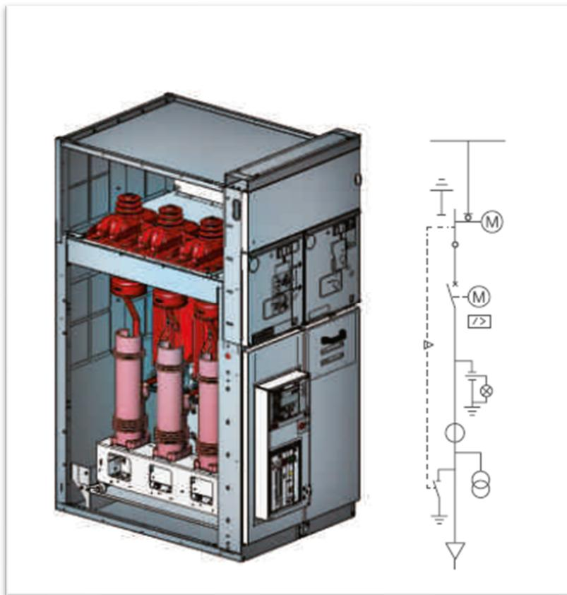
*Figura 10: scomparto protezione trasformatore*
