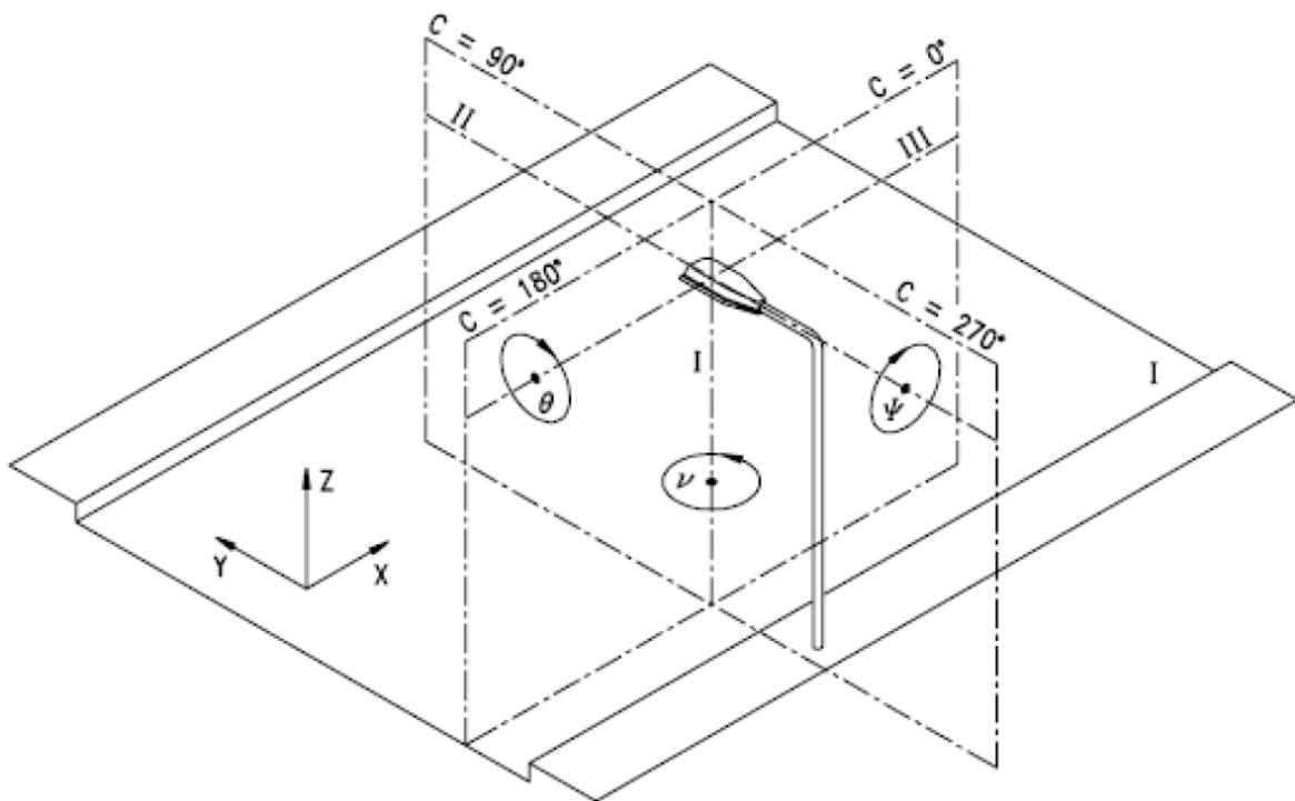
Ai fini del calcolo del flusso luminoso superiore, la norma UNI 10819 fornisce i valori degli angoli solidi parziali utilizzabili nel caso si disponga, per tutti gli apparecchi di illuminazione, nelle condizioni di installazione, dei prospetti di intensità luminosa (rilevati o calcolati per rotazione del solido fotometrico) per i valori d'angolo di 5° in 5°.
