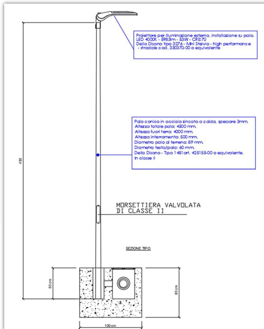
**Figura 1: apparecchio illuminante scelto in fase di progettazione definitiva per realizzare l'impianto di illuminazione perimetrale**
