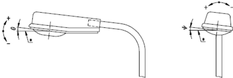
\* Traccia del piano orizzontale. Come rappresentato in figura l'angolo  $\theta$  è positivo, l'angolo  $\psi$  è negativo.
