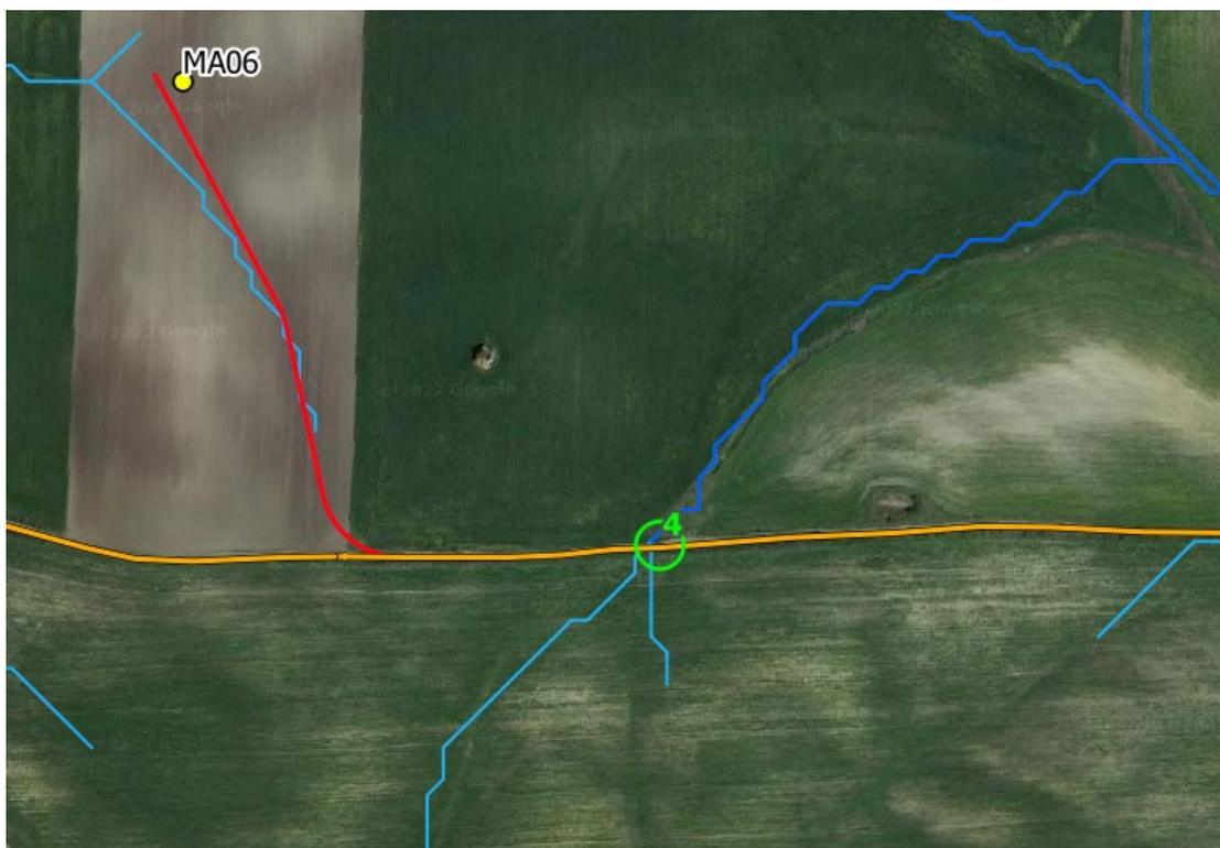
Figura 7—1: Interferenza n.4 lungo la viabilità da adeguare (in arancione) e un corso d'acqua episodico. In blu e celeste l'idrografia estratta dall'analisi del DEM.
