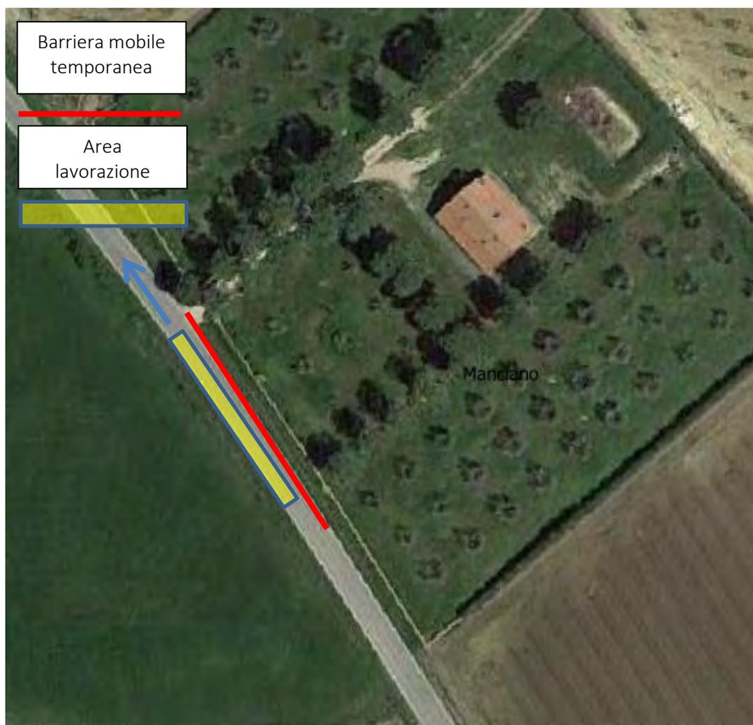
Figura 10.11 – Schema tipo del posizionamento delle barriere – particolare vicinanza di un ricettore
