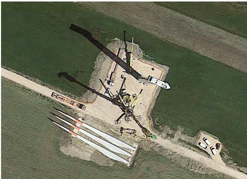
Figura 10.4 – esempio di piazzola in fase di costruzione
