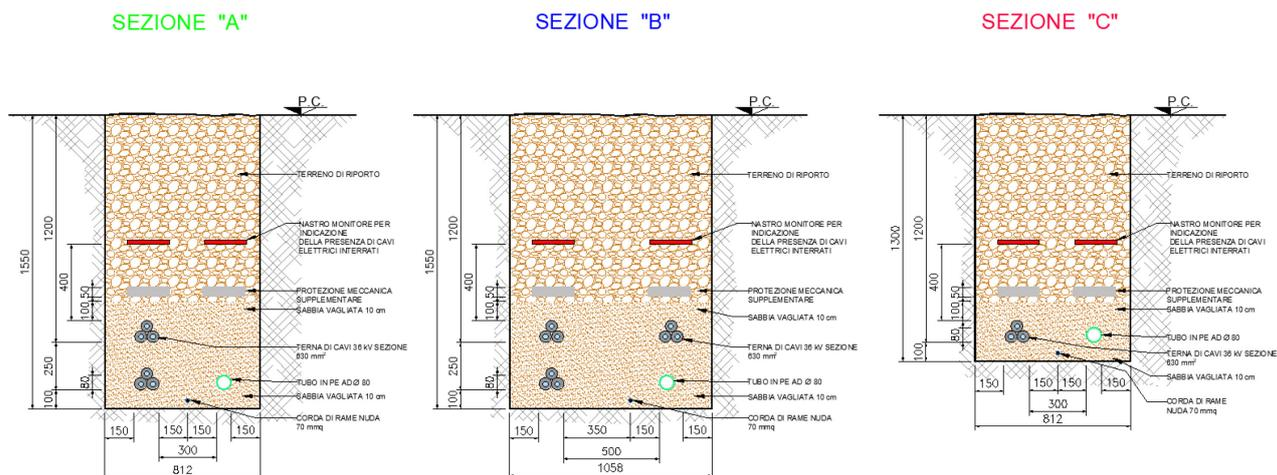
Figura 2.5 – Sezioni tipo posa cavidotti
