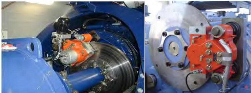
Figura 5.5: Sistemi di freno a disco sull'asse-rotore. Il sistema di controllo DTBird/Bat invia un segnale di frenata del rotore che fa variare il passo delle pale, le pinze bloccano il movimento residuo della rotazione
