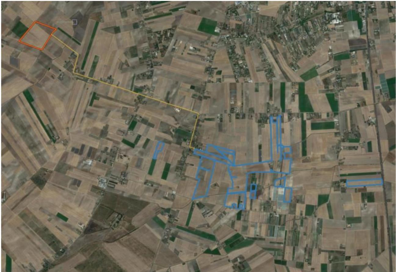
**Figura 13 - ORTOFOTO CON EVIDENZA DEL CAVIDOTTO TRA L'IMPIANTO E LA STAZIONE TERNA**
