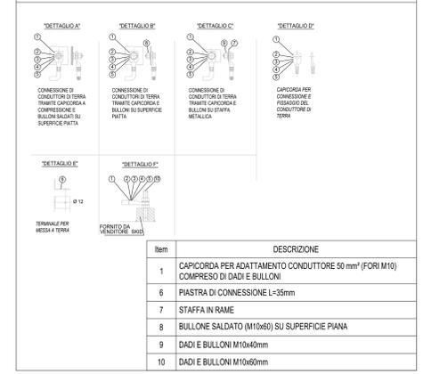
CONDUTTORI METALLICI SALDATI
