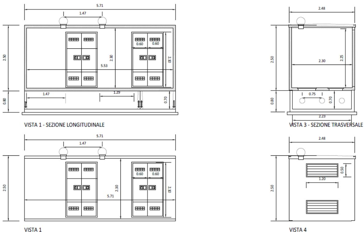
Figura 4.20: Prospetti rappresentativi delle Cabine di Sezionamento
