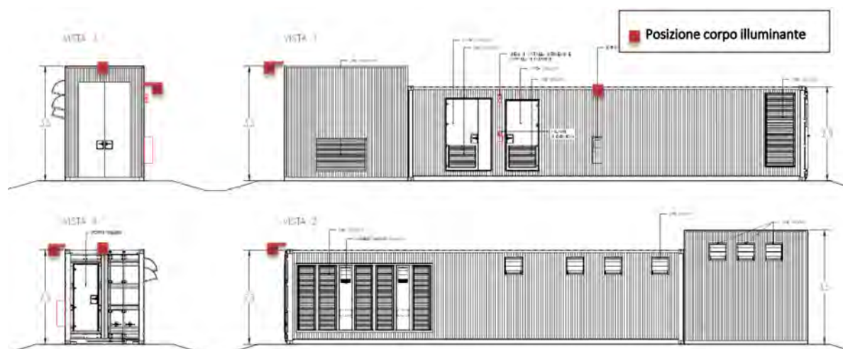
Figura 4.45: Esempio di cabina e relativa indicazione della posizione dei corpi illuminanti.
