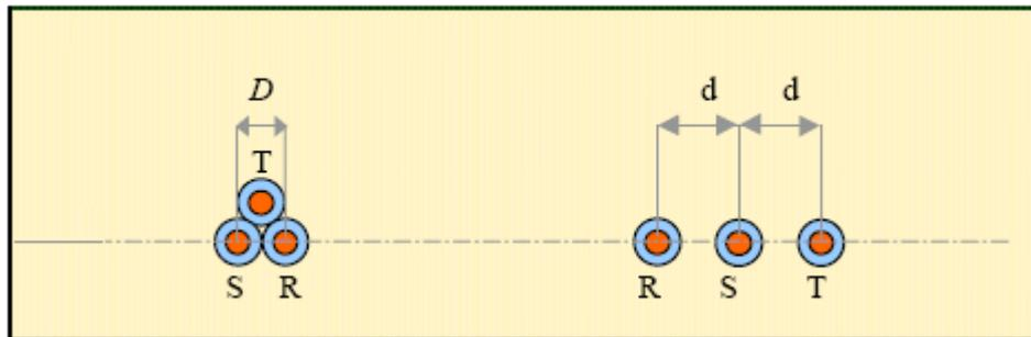
La posa a trifoglio riduce la portata di corrente ammissibile del cavo dovuta al regime termico che si instaura a causa della vicinanza dei cavi. Al contrario la posa in piano presenta livelli di portata in corrente proporzionali alla distanza "d" di interasse dei cavi.
