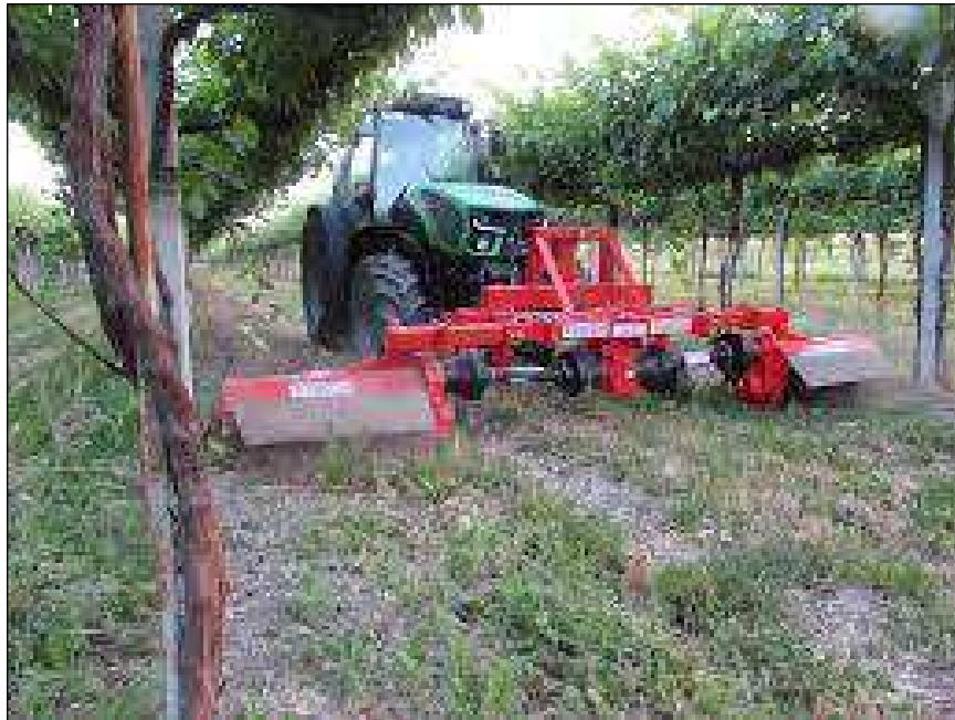
Figure 1 - Esempio di lavorazione con fresatrice bilaterale interceppo
