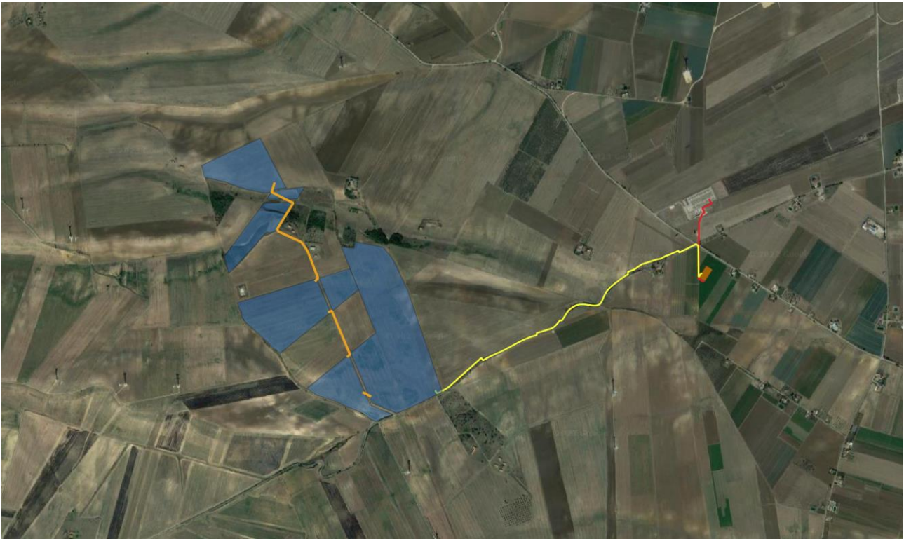
Figura 8-2: PTA - Aree Ulteriori, in blu la perimetrazione del sito, in giallo il tracciato della connessione MT, in rosso il tracciato della connessione AT
