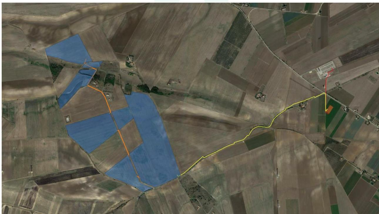
Figura 3-1: Localizzazione area di intervento, in blu la perimetrazione del sito, in arancione il collegamento in MT interno, il tracciato della connessione in giallo in MT e in rosso in AT.
