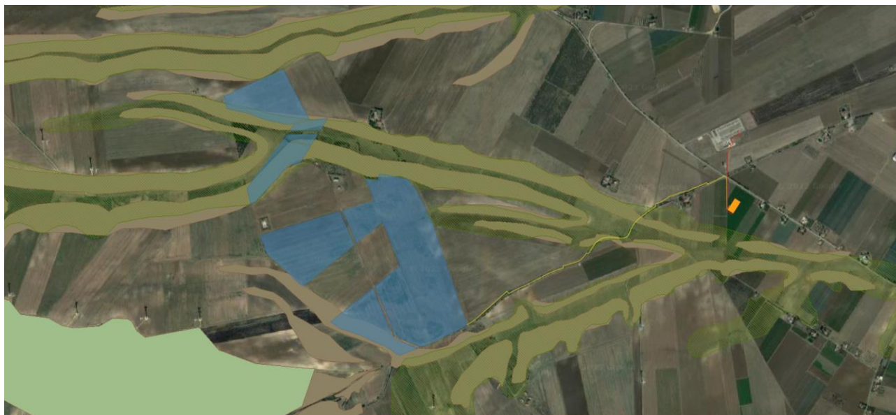
Figura 6-1: Interferenza progetto - struttura idro-geomorfologica PPTR, in blu la perimetrazione del sito, in giallo il tracciato della connessione MT, in rosso il tracciato della connessione AT
