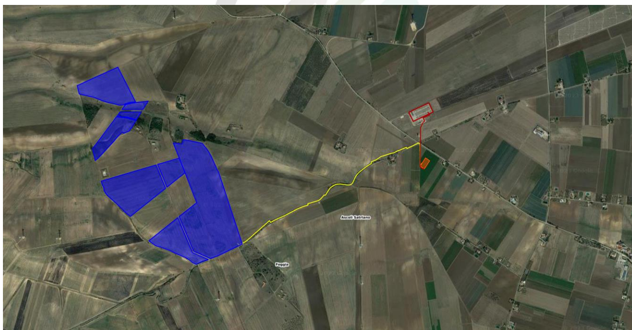
Figura 3-6: Inquadramento Vincoli in Rete; in giallo il tracciato della connessione MT, in rosso il tracciato della connessione AT
