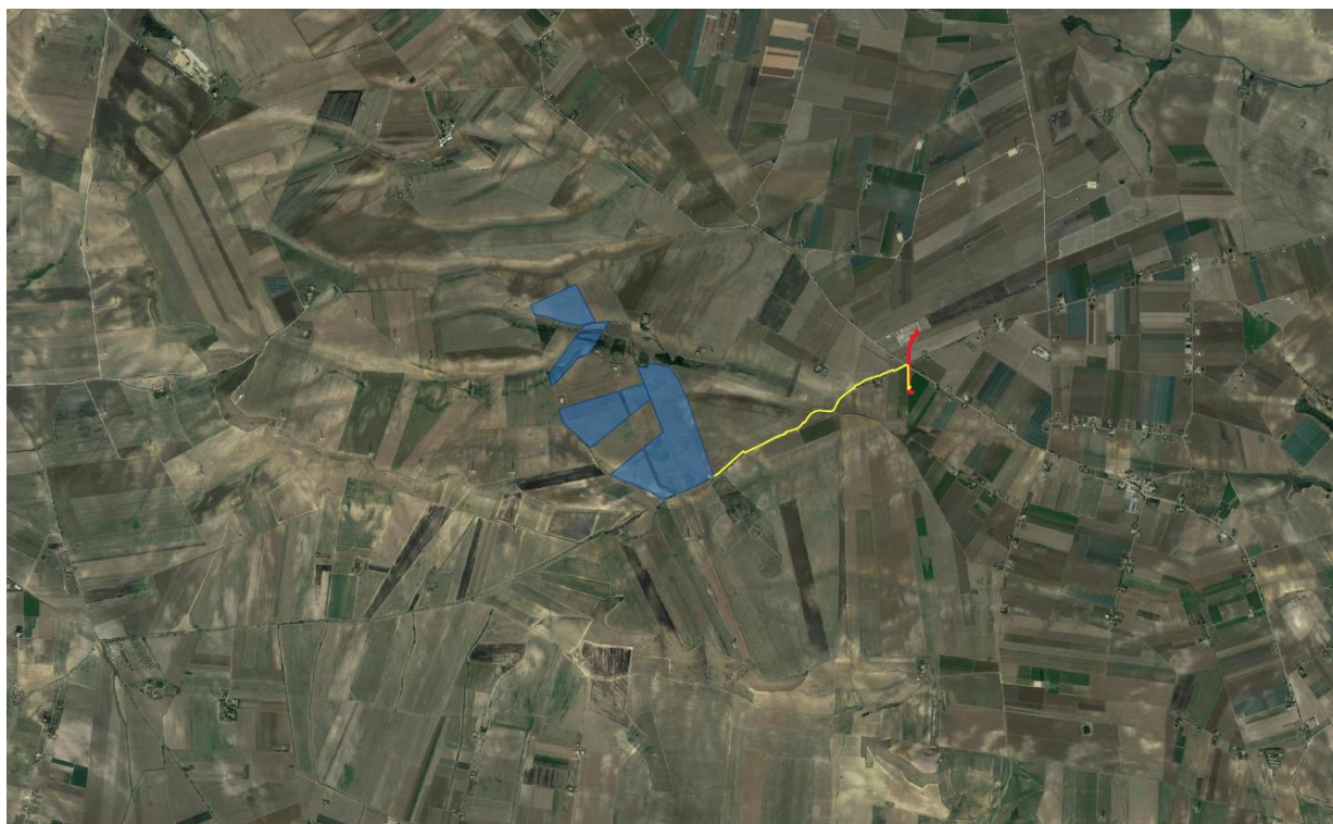
Figura 3-2: PTA: - Aree Ulteriori, in blu la perimetrazione del sito, in giallo il tracciato della connessione MT, in rosso il tracciato della connessione AT
