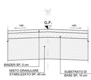
**SEZIONE TIPO IN RILEVATO**
