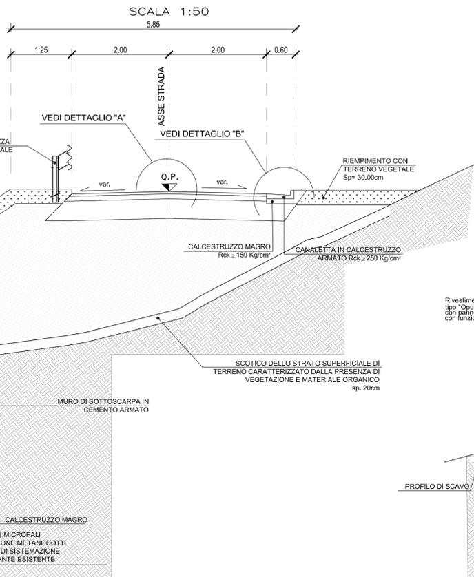
**SEZIONE A MEZZACOSTA CON PIAZZOLA DI SOSTA EMURO DI SOTTOSCARPA**
