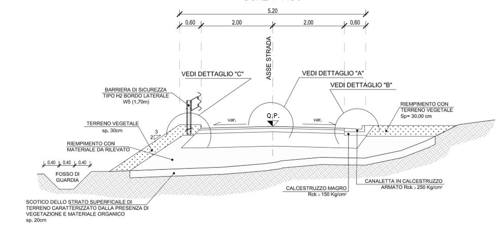
DAL KM 0 AL KM 0+090 SOVRAPPONIMENTO CON LA VIABILITA' ESISTENTE (VIA ADDA). LA LAVORAZIONE DA ESEGUIRE CONSISTE NEL RIFACIMENTO DEL PACCHETTO DI NERI DELLA PAVIMENTAZIONE:
