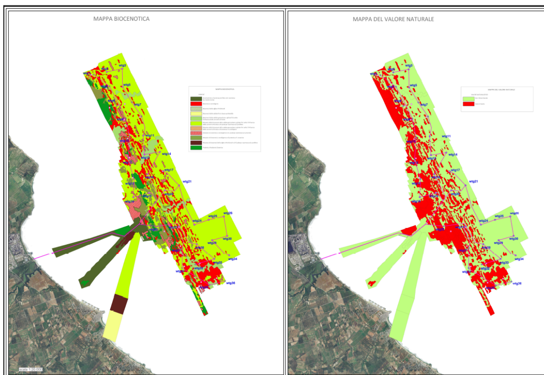
Figura 4.14: elaborati grafici del progetto dell'impianto eolico offshore di Brindisi – proponente TG Energie Rinnovabili con rilievi della Poseidonia e delle biocostruzioni presenti
