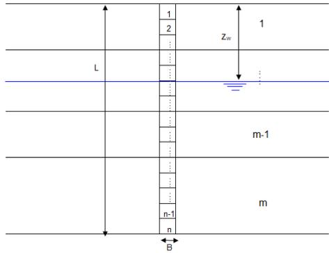
2. Definizione della resistenza limite del palo sulla base delle caratteristiche geometriche e delle caratteristiche del terreno. In presenza di terreno stratificato la resistenza sarà uguale alla sommatoria delle resistenze limite di ogni strato di terreno attraversato dal palo.
