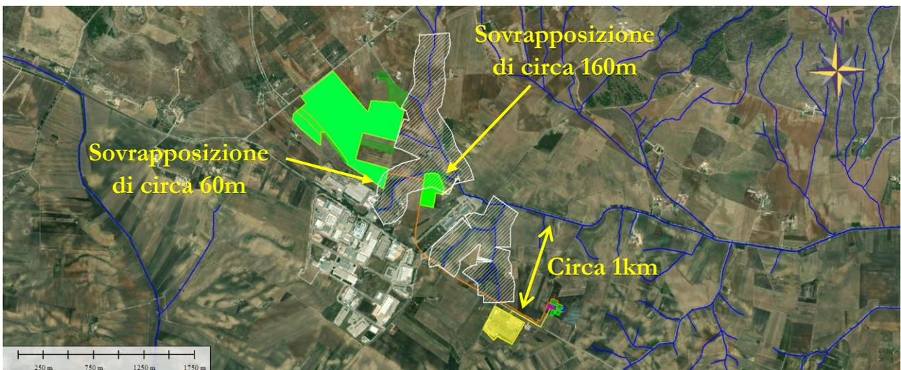
Figura 7. Buffer di 150m e distanze dell'elettrodotto dal corso d'acqua principale di nord.
