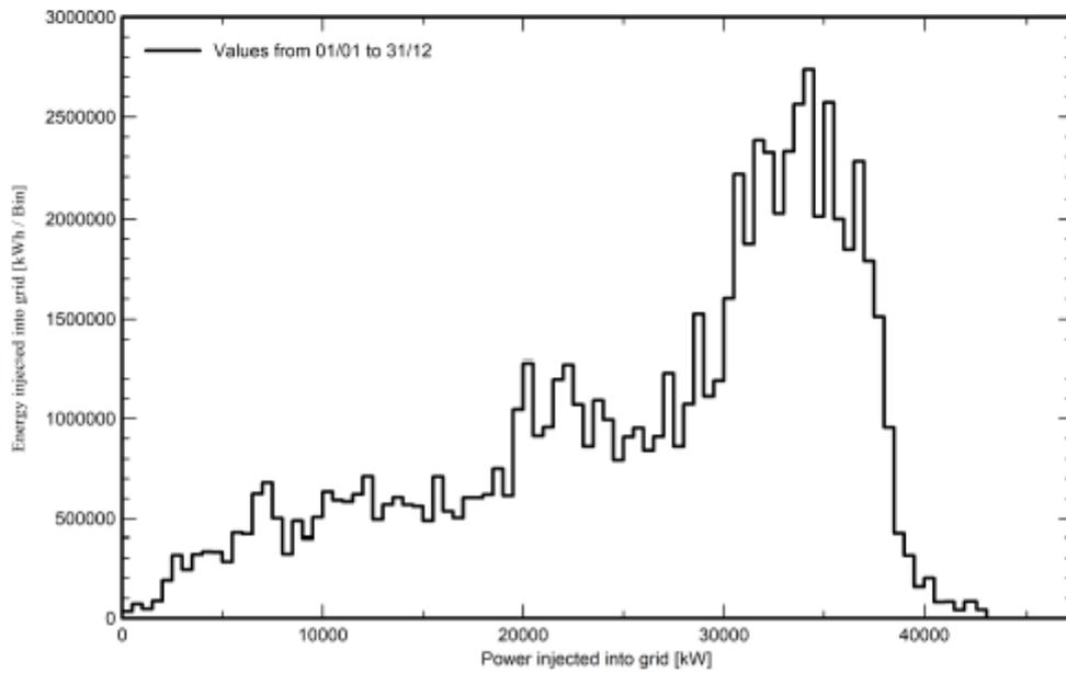
Dai dati di simulazione si denota che l'impianto sarà in grado di produrre circa **76.509 MWh/anno**, con una producibilità specifica annua di 1.771 kWh/kWp installato.
