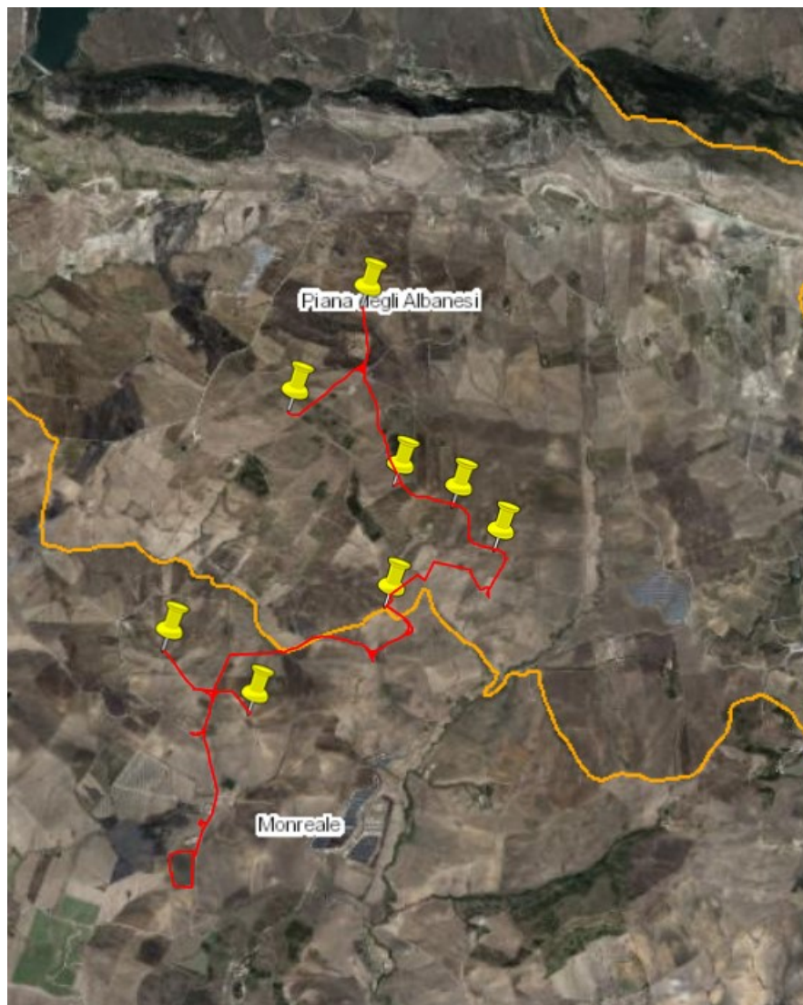
Figura - L'impianto (posizionamento degli 8 aerogeneratori, sottostazione di servizio e cavidotti) su ortofoto.
