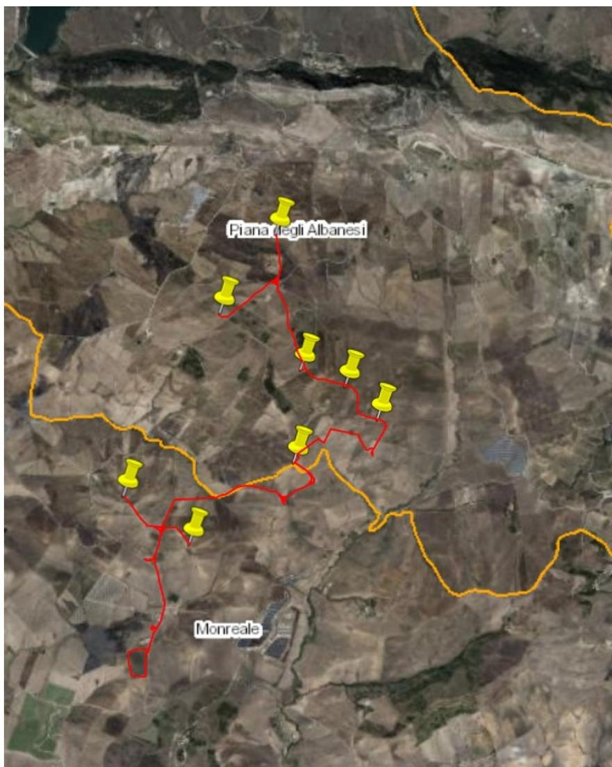
**Figura 9** - L'impianto (posizionamento degli 8 aerogeneratori, sottostazione di servizio e cavidotti) su ortofoto.
