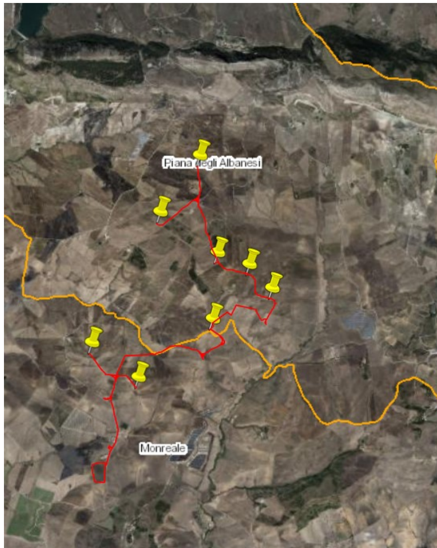
Figura - L'impianto (posizionamento degli 8 aerogeneratori, sottostazione di servizio e cavidotti) su ortofoto.
