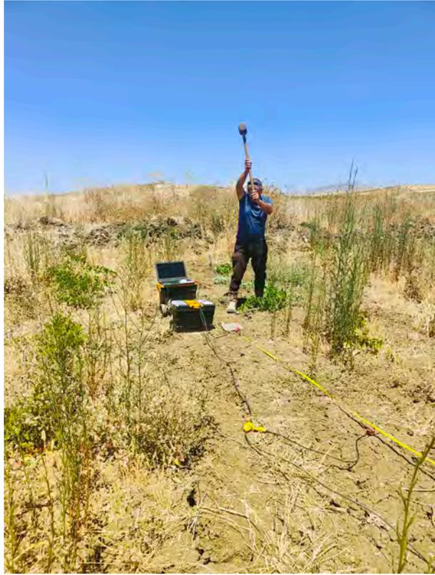
Fig. n. 48 – Campo 3- esecuzione indagine geofisica (traversa sismica TS1 e masw1)
