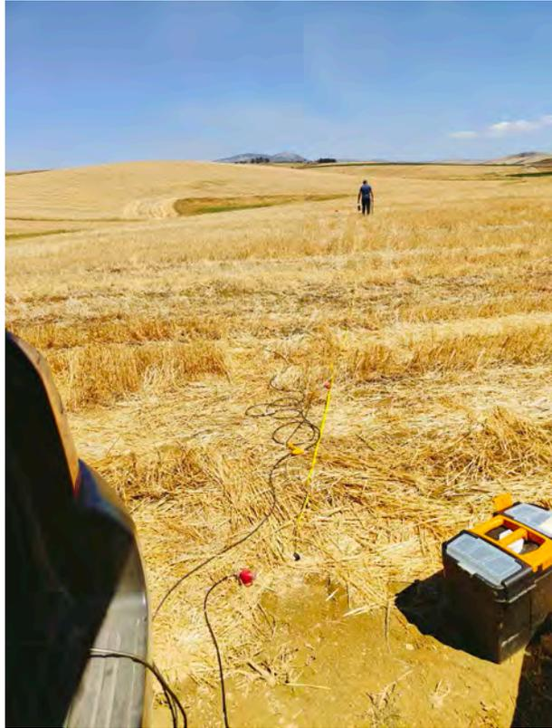
Fig. n. 54 - --Campo 1 - esecuzione indagine geofisica (traversa sismica TS4 e masw4)
