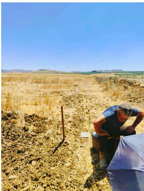
Fig. n. 4 – Campo 4- esecuzione indagine geofisica (traversa sismica TS2 e masw2)
