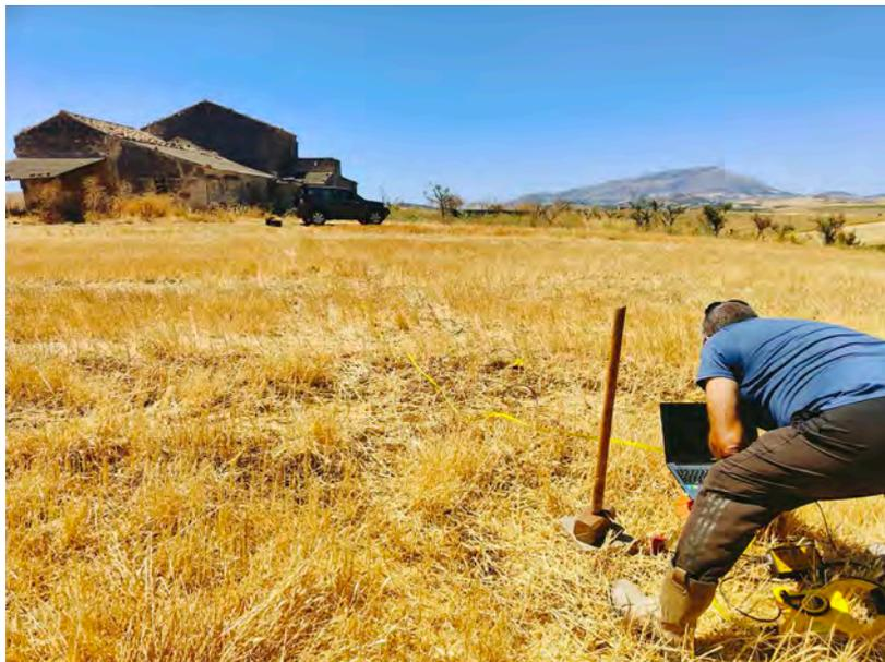
Fig. n. 55 - --Campo 1 - esecuzione indagine geofisica (traversa sismica TS4 e masw4)
