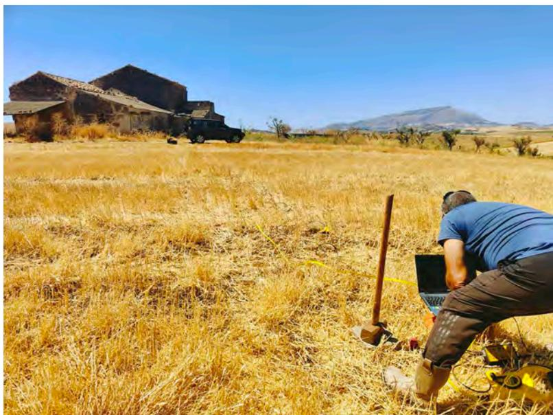
Fig. n. 10 - --Campo 1 - esecuzione indagine geofisica (traversa sismica TS4 e masw4)
