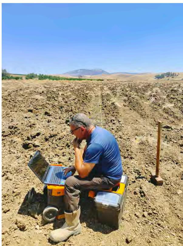
Fig. n. 6 – Campo 2- esecuzione indagine geofisica (traversa sismica TS3 e masw3)
