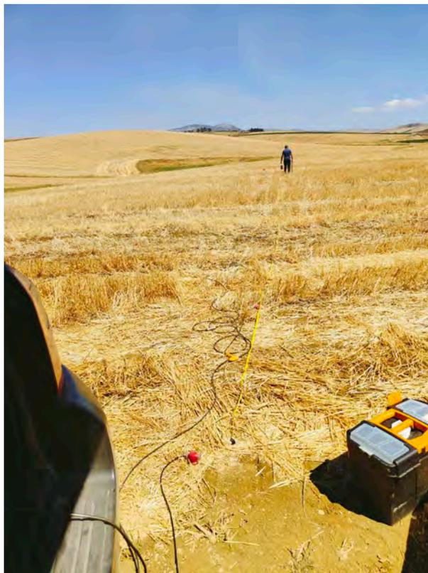
Fig. n. 9 - --Campo 1 - esecuzione indagine geofisica (traversa sismica TS4 e masw4)
