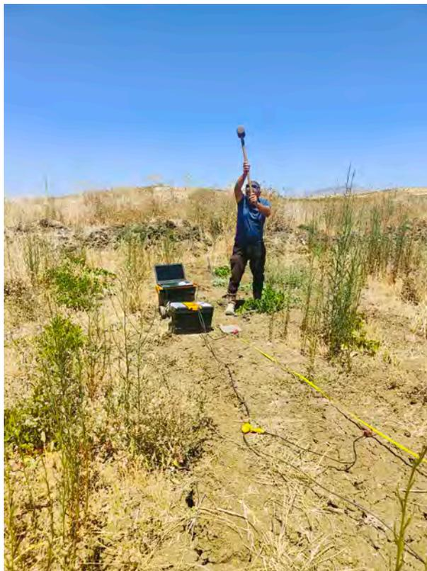
Fig. n. 3 – Campo 3- esecuzione indagine geofisica (traversa sismica TS1 e masw1)
