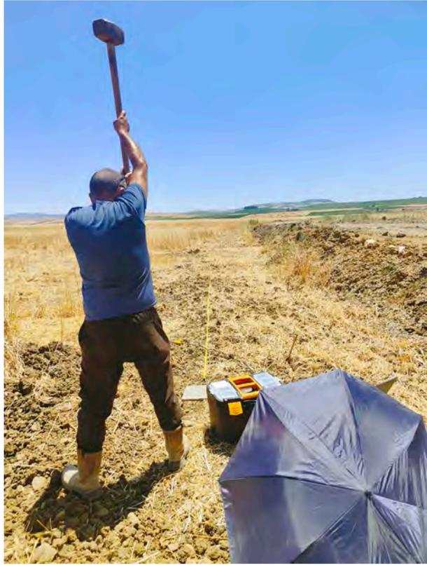
Fig. n. 50 – Campo 4- esecuzione indagine geofisica (traversa sismica TS2 e masw2)
