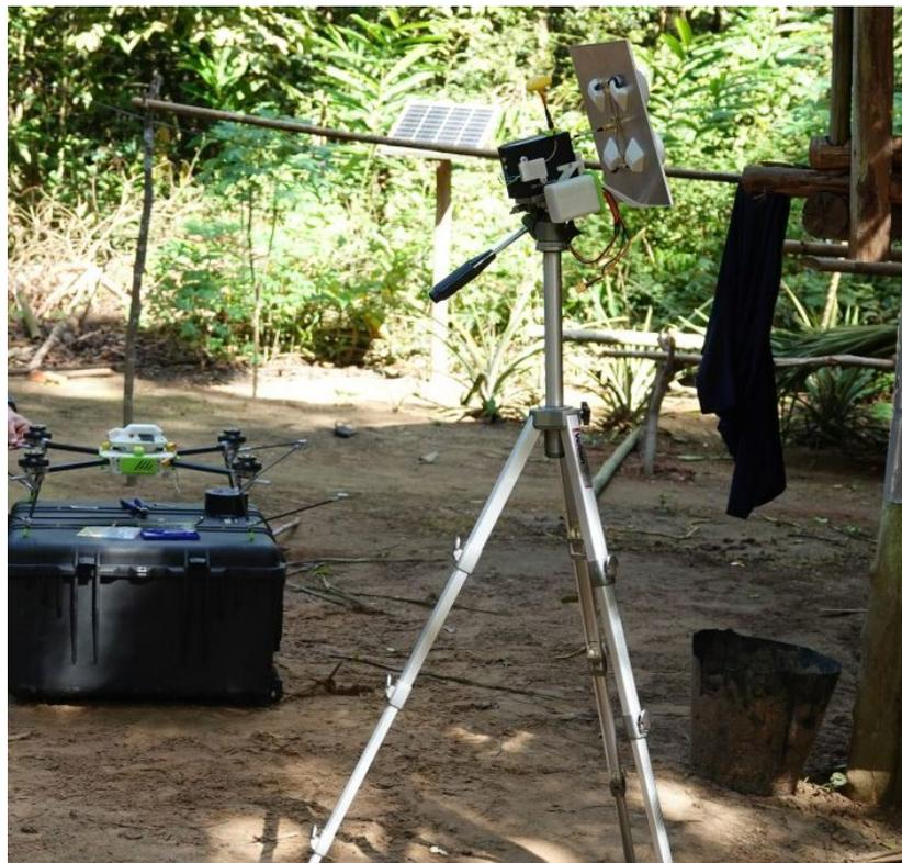
Esistono testimonianze di aziende che impiegano nella gestione delle proprie coltivazioni sofisticati kit dotati di sensoristica avanzata, con batterie ad alimentazione solare, che dispongono di sensori ambientali-vegetazionali e meteorologici. I kit si compongono di un sistema di water intelligence che
