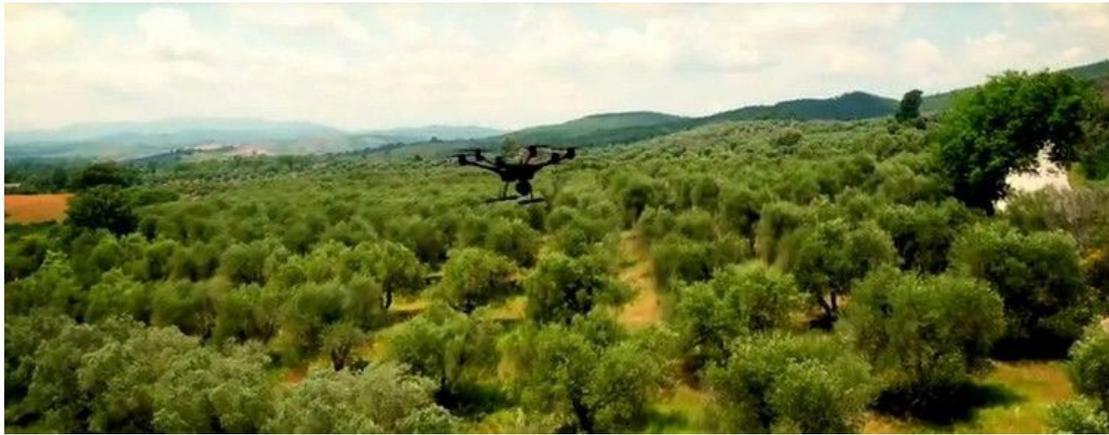
Il monitoraggio di parametri climatici, fenologici e produttivi può essere effettuato con droni o con kit prossimali basati su tecnologie in cui il sensore remoto (remote sensing) è a diretto contatto con l'oggetto da monitorare: terreno, foglie, frutto, ecc.
