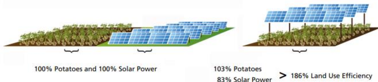
Figura 54: LER rilevato per l'impianto sperimentale di Heggelbach nel 2017 e nel 2018 (Fonte: Trommsdorff M. et al., 2020)
