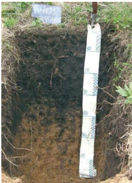
Foto 5 Scavo di saggio per prelievo campioni per sostanze organiche
