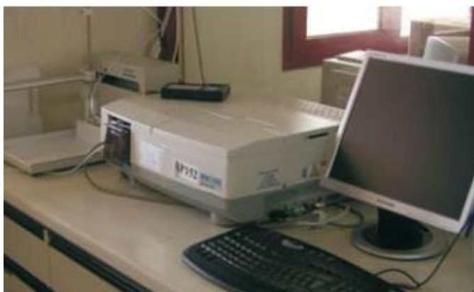
Foto 4 Spettrofotometro per l'analisi colorimetrica del fosforo assimilabile
