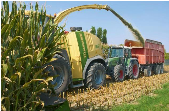
Figura 7.12: Soluzione tecnica con cassone di raccolta posto dietro la raccogliitrice.
