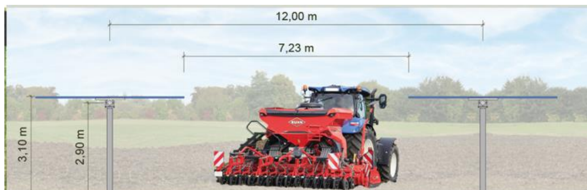
Figura 7.5: Particolare sezione trasversale con esempio di passaggio di una seminatrice. (Estratto da Doc. No. REN-176-T.30.c - Mitigazioni paesaggistico-ambientali e progetto agro-energetico)
