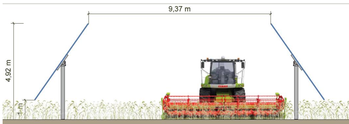
Figura 7.4: Particolare sezione trasversale con macchina agricola in azione. (Estratto da Doc. No. REN-176-T.30.c - Mitigazioni paesaggistico-ambientali e progetto agro-energetico)
