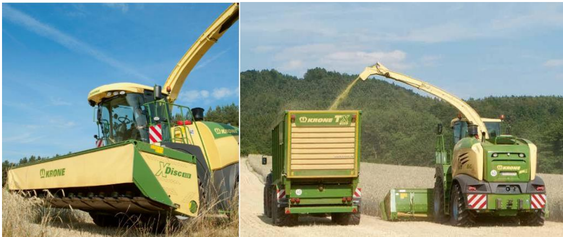
Figura 6.30: Testata e falcia-trincia-caricatrice impiegate sui terreni.
