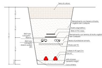
Sezione tipo cavidotto AT doppia termica in terreno vegetale all'interno dell'impianto agrivoltico
