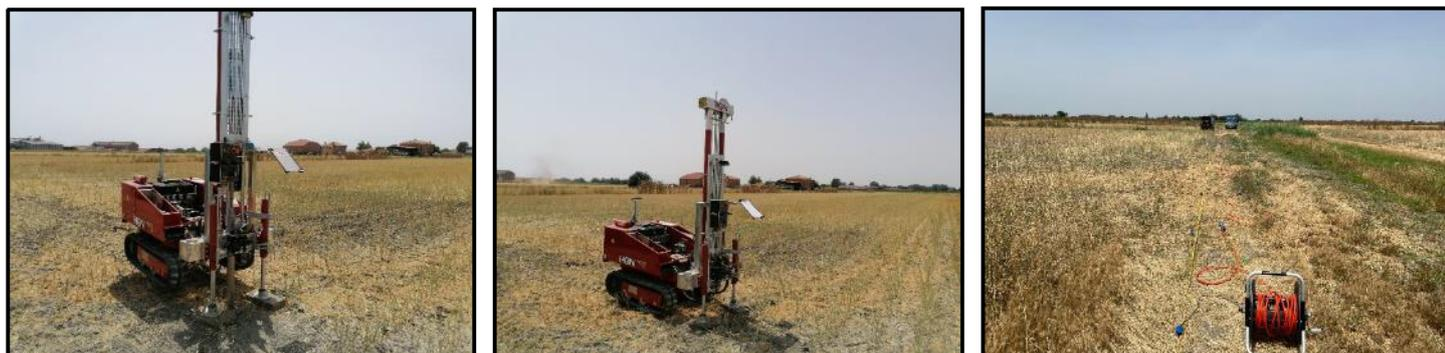
*Indagini geognostiche: sondaggio a percussione, prova penetrometrica e prospezione geofisica MASW.*
