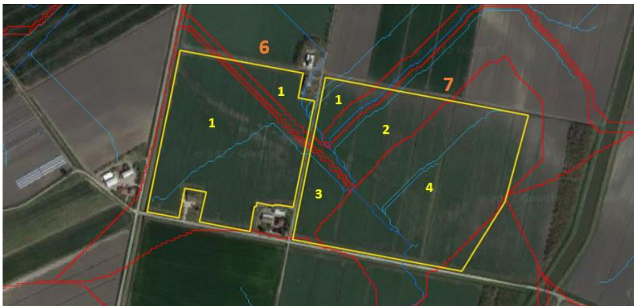
Figura 51: Delimitazione bacini scolanti e codifica (giallo), reticolo di drenaggio esterno ed interno alle sezioni di progetto (blu) e limiti bacini idrografici (rosso).
