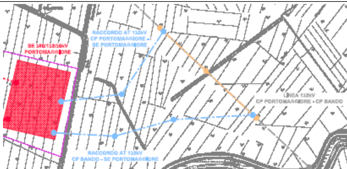
Raccordi con la linea 132 kV
