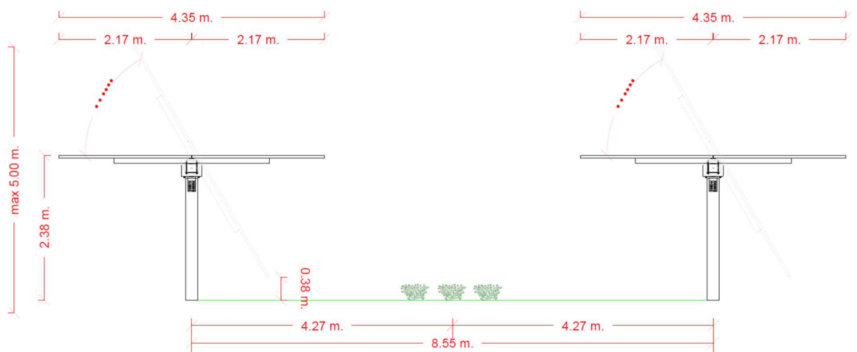
Schema coltivazione agro-fotovoltaico
