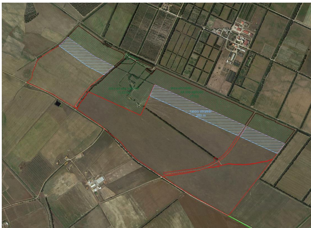
Figura 5.9: Fascia di rispetto di 150 m adibita ad area verde e aggiuntiva fascia Strahler di prima salvaguardia di ulteriori 100 m.
