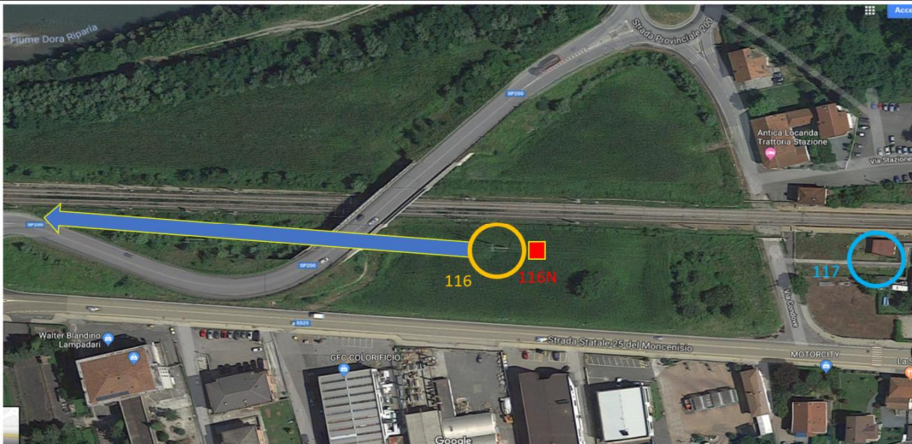
**Fig.2. Individuazione di massima del cavidotto e del nuovo sostegno di ormeggio 116N da realizzare al posto del demolendo sostegno esistente 116.**
