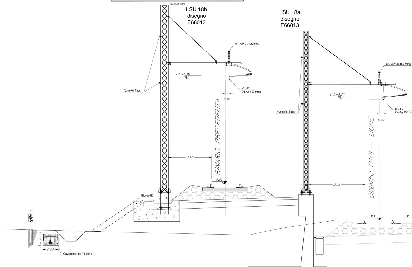
SEZIONE TIPOLOGICA PALI CORSA/PRECEDENZA
