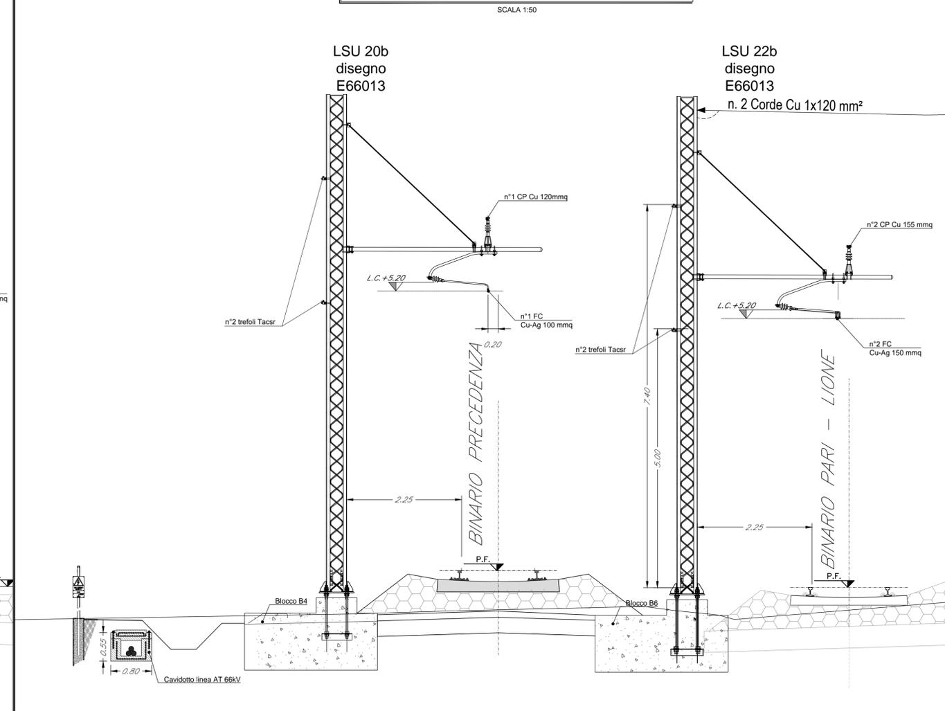
SEZIONE TIPOLOGICA PALO NORMALE CON ATTRAVERSAMENTO AEREO
