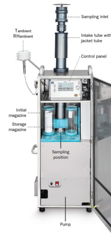
Figura 4-1 Campionatore sequenziale automatico
