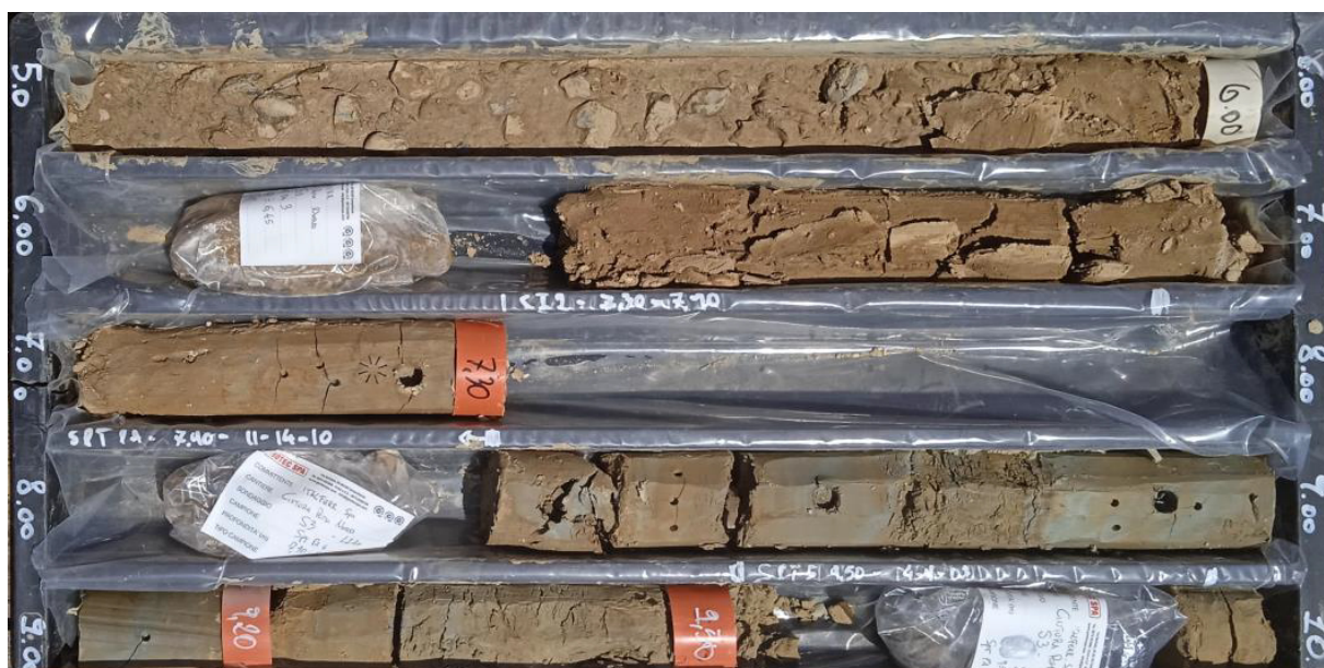
Figura 13 – La litofacies sabbioso-limosa (bb2) nella parte alta della cassetta 2 del foro di sondaggio L1APS03 e la litofacies argilloso-limosa (bb3), nella parte bassa della cassetta 2 del foro di sondaggio L1APS03, dei Depositi alluvionali recenti.
