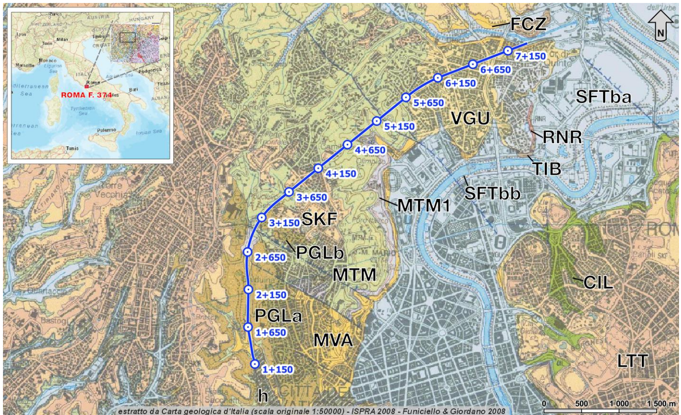
Figura 10 – Stralcio della Carta geologica d'Italia n. 374 "Roma" scala originale 1:50000, riprodotto in scala 1:120000, con indicazione delle tratte di progetto.
