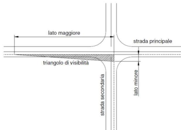
Il lato minore del triangolo di visibilità sarà commisurato ad una distanza di 20 m dal ciglio della strada principale, per le intersezioni regolate da precedenza, e di 3 m dalla linea di arresto, per quelle regolate da stop.
