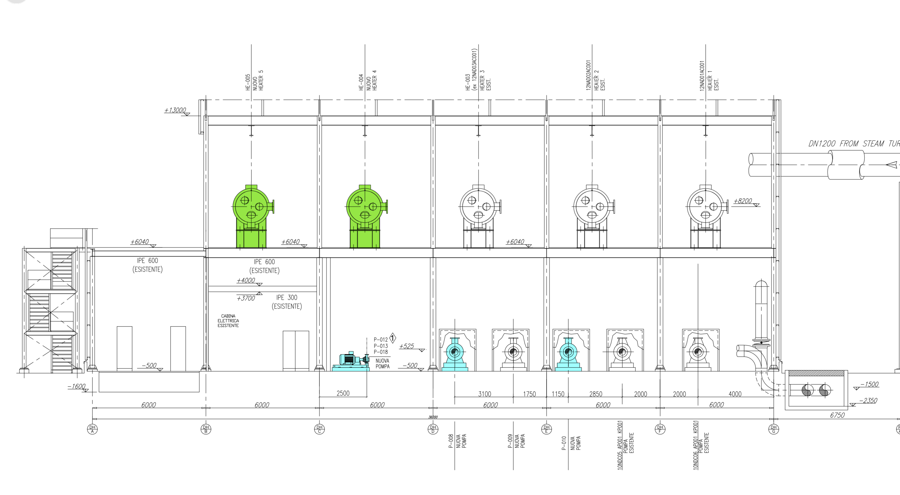
3 SEZIONE A-A EDIFICIO SCAMBIATORI SCALA 1:100
