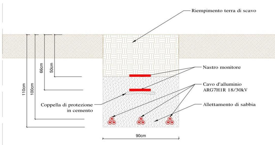
Figura 1: Modalità di Interramento della Linea MT
