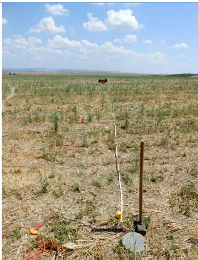
FOTO 1:allineamento della base sismica 1 vista dal punto di scoppio A
