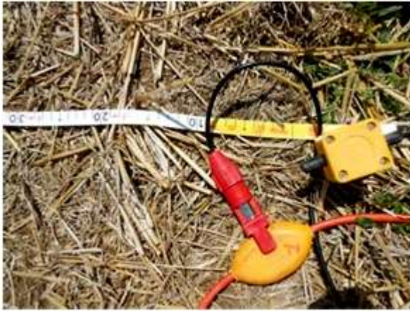
FOTO 3: geofono 1 a 0,00 metr
