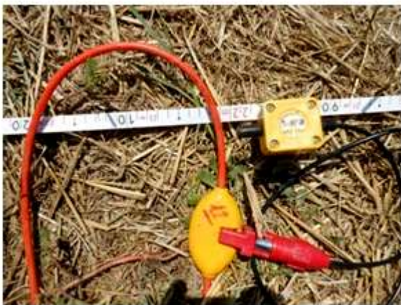
FOTO 4: geofono 12 a 22,00 metri
