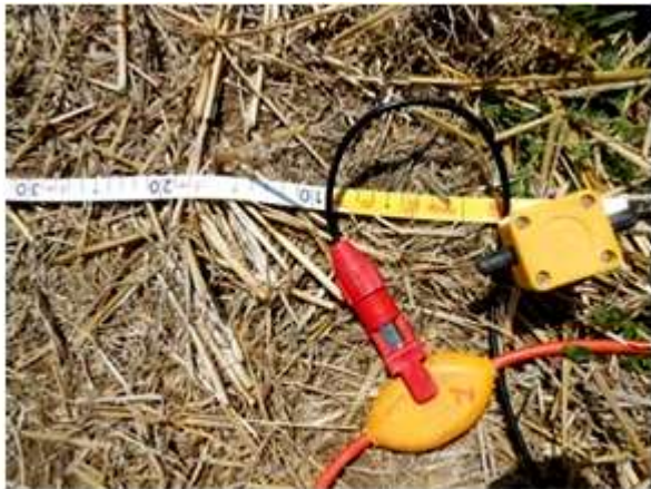
FOTO 3: geofono 1 a 0,00 metr
